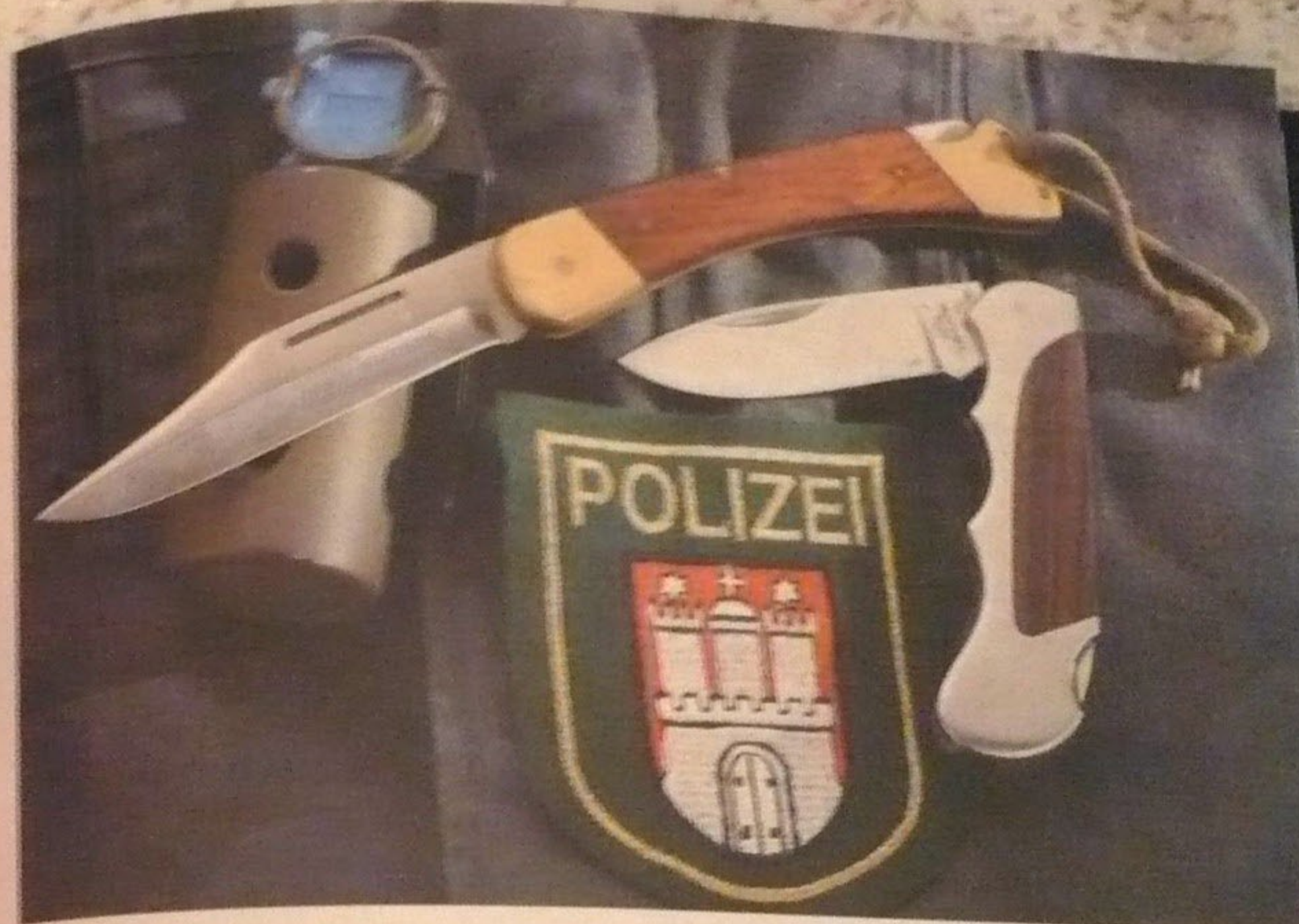
70-е и 80-е годы. Классические складные ножи с фиксатором клинка в нижней части спинки рукоятки (Lock Back): нож Баймаршден (Bismarckden) фирмы «Пунс» и нож фирмы «Штупер», фирм Томас Рупль (Thomas Ruppel)
