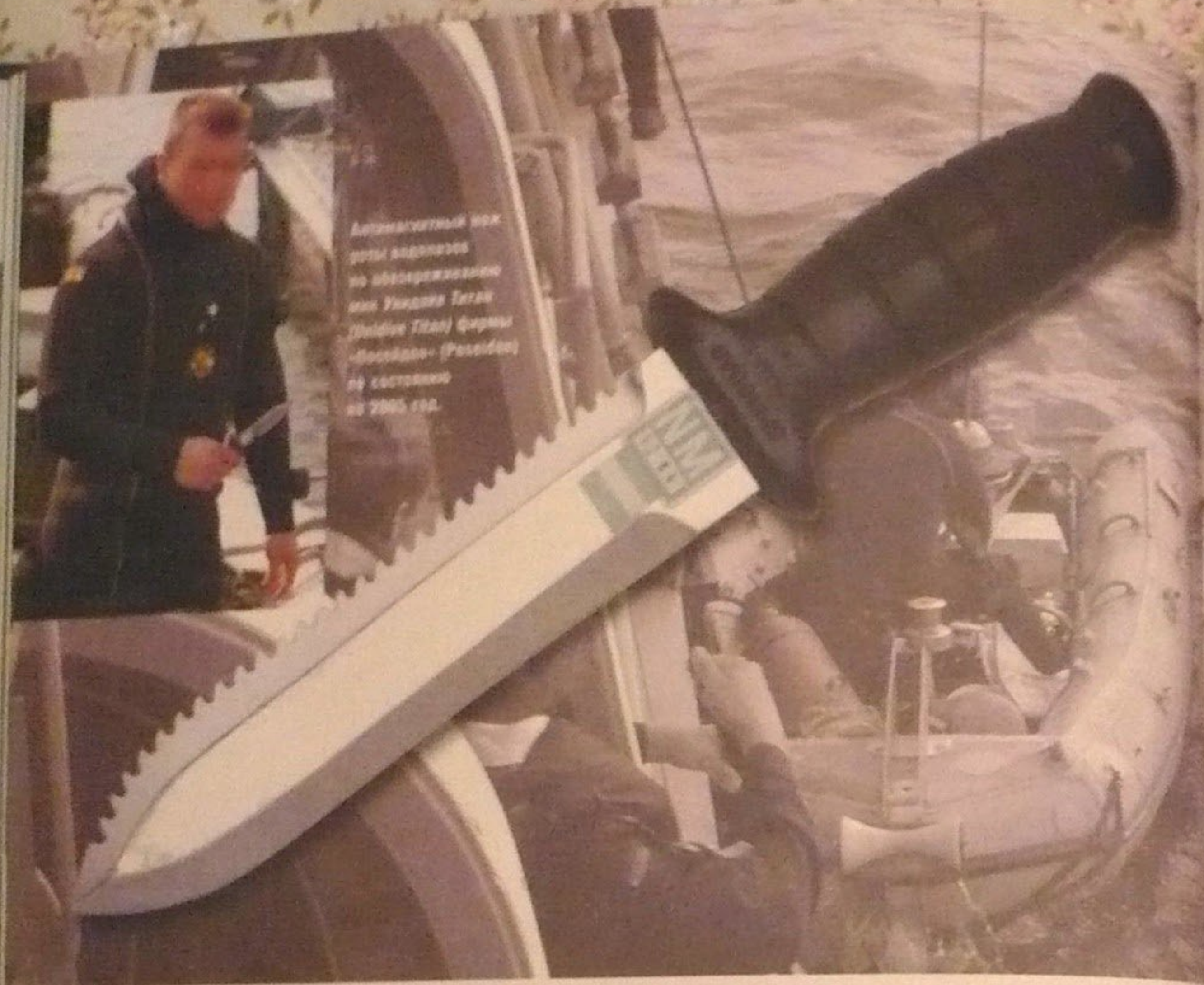
Водолазный нож Spirodag (Spirodag) французской фирмы La Spirotechnique был первым антимагнитным ножом водолаза по обезвреживанию мины, имевшим уровень квалификации A (Level A) . Бело-зеленая наклейка с буквами NM указывает на то, что данный предмет снаряжения не поддается намагничиванию.
